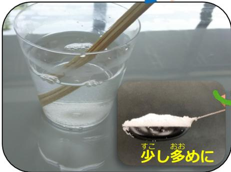
① プラスチックコップに食塩大さじ2杯(約40g)と、水100mLを入れて、よくかき混ぜます。
